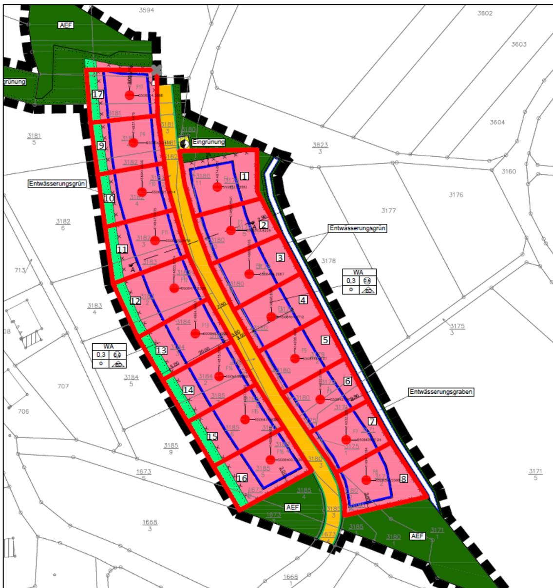
Abbildung 1: Auszug aus dem vorliegenden Lageplan mit eingezeichneter Aufteilung der Bauplätze und Nummerierung auf Grundlage des Bebauungsplans [1]
