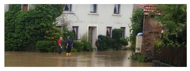
Dabei kann Hochwasser über unterschiedliche Wege in Gebäude gelangen bzw. auf diese einwirken: Hochwasser kann durch tiefliegende, nicht überflutungssichere Gebäudeöffnungen, also Hauseingänge und Fenster einströmen.
