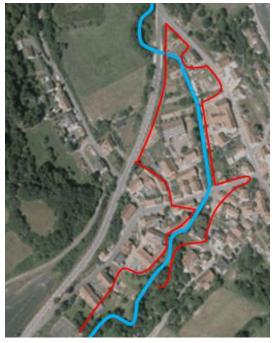
Am Pegel Obermoschel wurde gegen 20:30 Uhr der Hochwasserhöchststand erreicht. Die Hochwasserspitze von 35 m³/s am Pegel Obermoschel dauerte 30 Minuten an und über einen Zeitraum von mindestens einer Stunde wurde ein Abfluss größer als 30 m³/s erreicht. Da der Pegel Obermoschel unterhalb von Sitters liegt und die Flutwelle durch Obermoschel bereits eine weitere Dämpfung erfahren hat, ist davon auszugehen, dass in Sitters höhere Abflussspitzen erreicht wurden.
