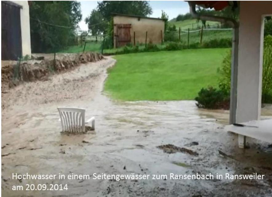
Im Normalfall wird Hochwasser an dem Gebäude vorbei strömen. Bei Starkregen kann sich Hochwasser vom Hang jedoch bereits auf der Gebäuderückseite fangen und Schäden verursachen.
