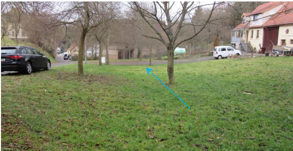
Hochwasser wird weiter dem Gefälle des Brüschwegs folgen und auf dem Weg in tiefliegende Höfe und Gebäude eindringen und Schäden verursachen (s. auch Abschnitt 7.12.13). Die Abflussmodellierung von Palaterra/Areal (s. auch Abschnitt 5) zeigt deutlich, wie sich das Wasser einer Sturzflut auf und neben dem Brüschweg ausbreiten würde.
