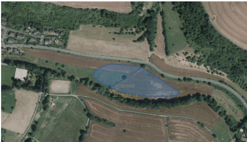
einer Stelle im rechten Vorland bis auf eine Breite von 80 bis 90 m auf. Hier könnte im Nebenschluss zwischen Bach und Straße ein Polder mit einer Staufläche von maximal  $10.000 \text{ m}^2$  eingerichtet werden. Bei einer Stautiefe von im Mittel etwa  $0,5 \text{ m}$  wäre damit ein Stauvolumen von etwa  $5.000 \text{ m}^3$  zu erreichen.
