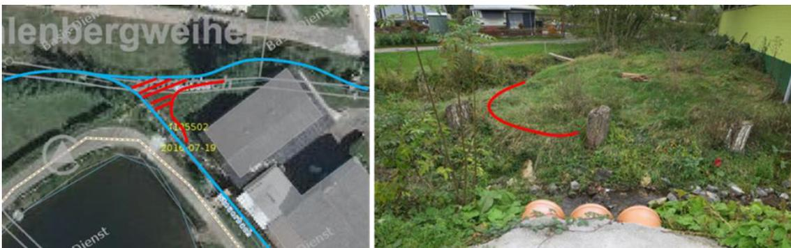
Außerdem bietet sich der Gerbach zwischen der Brücke der Zufahrtsstraße und der Einmündung des Steuerbachs für eine Aufweitung an (Bilder unten). Hier wird empfohlen die Sohle zu verbreitern und das rechte Ufer flacher anzulegen. Dort wo der Weg parallel verläuft sollte eine solche Maßnahme mit Verwallungen oder Mauern im Sinne einer Objektschutzmaßnahme für die angrenzenden Gebäude kombiniert werden (s. Abschnitt 8.17).
