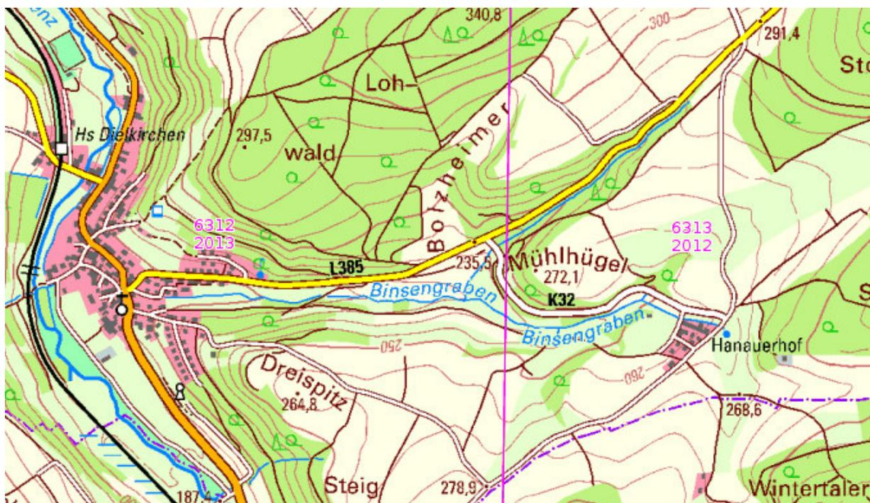
Ab der Ortslage Dielkirchen ist der Bach begradigt. Am oberen Ende der Bachstraße endet der offene Bachlauf in einem Geröllfang und geht in eine Verrohrung zur Alsenz über.
