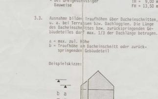
Abgeschrägte Dächer dürfen nur bis auf die Hälfte der Höhe des Vollgeschosses unter dem Dachgeschoß geführt werden.
